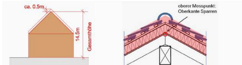
Die Gesamthöhe wird bis zum höchsten Punkt des Daches gemessen, wobei hierzu nicht der höchste Punkt über Grund, sondern der höchste Punkt über Meer verwendet wird. Bei speziellen Dachformen und in Hanglage ist damit die Gesamthöhe nicht brauchbar.
